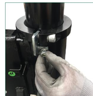
Bei unseren Stabilisator Serien EVO und EVO X haben die Abstützylinder den Ölanschluss seitlich, geschützt vor plötzlichen Stößen und herabfallenden Gegenständen. Die Abstützylinder für Modelle ab EVO 08 mit max. 3.100 bis Modelle EVO 48 mit max. 10.500 daN können dank unseres LOCK RING-Systems der neuen Generation, in der Höhe reguliert werden.
