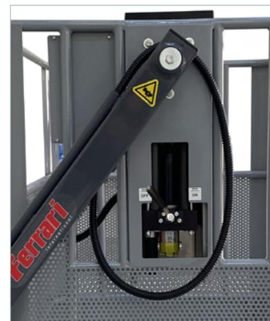
Auf dem Stellantrieb ist ein Sicherheitsknopf installiert, der im Bedarfsfall den Ausleger manuell blockieren oder freigeben kann. Im Notfall kann der Knopf abgedreht und der Korb nach der Schwerkraft ausbalanciert werden. Die hydraulische Anlage ist so vollständig selbstversorgend und unabhängig von der Vorrichtung, auf der der Korb installiert ist.
