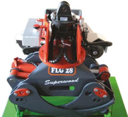
LEISTUNGSFÄHIGES MOTORSÄGEN-KIT, GEEIGNET FÜR DIE MONTAGE AUF FERRARI FLG SUPERWOOD HOLZGREIFER SERIE
