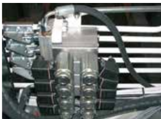
Installation an Kranen mit 2-facher Flursteuerung (2 Bedienstände) Installation on crane dual controls
